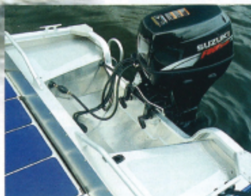
Die Lenkung ist vorgerüstet, Kraftstoffleitung und Fernbedienung werden bei der Motormontage ausgeführt
