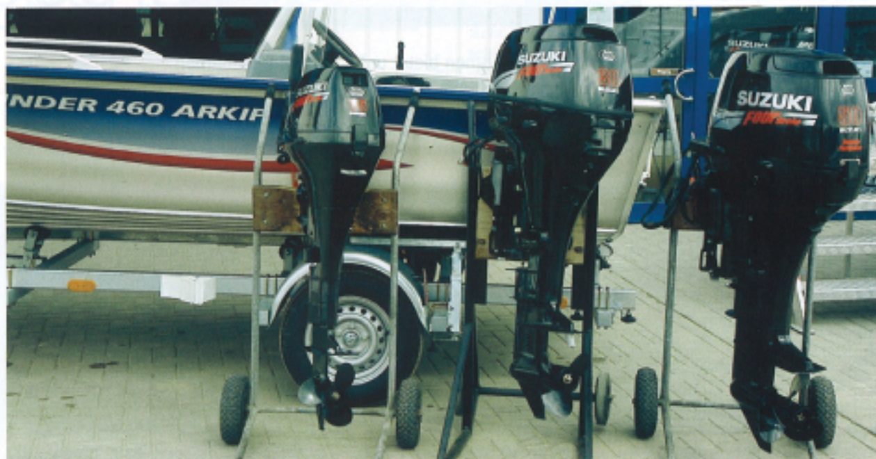
Wie es euch gefällt... Die Linder Arkip 460 lässt sich ganz nach individueller Neigung mit bis zu 37 kW (50 PS) motorisieren. Im Bild unsere drei Motorvarianten Suzuki BF 15, BF 30 und BF 50
