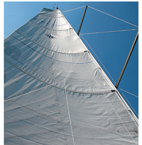
Das Rigg mit zwei gepfeilten Salings und Squarehead.
