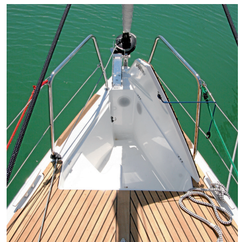
Der Bug mit großzügigem Ankerkasten und Podest für die Ankerwinde.
