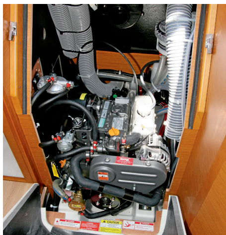
Der Motor unter dem Niedergang ist gut zugänglich und solide installiert. Für gute Schalldämmung ist der Motorraum hermetisch verschlossen. Die Verbrennungsluft kommt über ein Gebläse.
