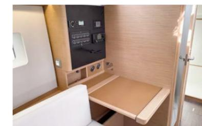
Bien qu'elle soit petite et que le navigateur doit s'asseoir dans le sens opposé à la marche, il y a toujours une table de navigation sur un Jeanneau. Un smartphone et éventuellement un iPad pourront y être posés. L'électronique est soigneusement installée derrière le panneau d'interrupteurs. Et même ailleurs, un coup d'œil derrière la «façade» en vaut la peine, car le Sun Odyssey 380 n'a rien à cacher.
