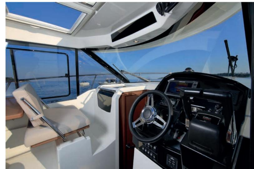
Gesamttrimmschalter ist am Gashebel zusätzlich angebracht. Es ist doch ein wenig störend, bei Vollgas jedesmal die Einzeltrimmung wieder neu zu justieren. Dort könnte ein aufklappbarer Schutzdeckel Abhilfe schaffen, damit die Trimmung nicht bei jedem Gas geben betätigt wird.
