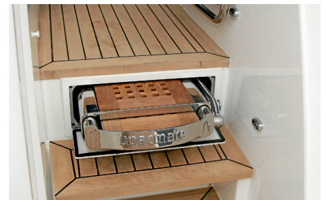
Die Gangway verschwindet zwischen den Stufen der Hecktreppe.
