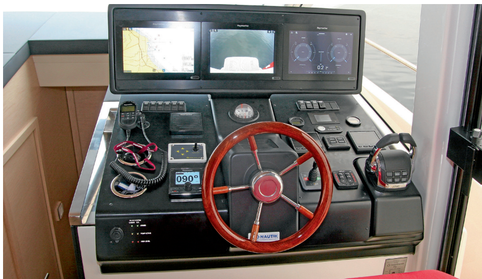
Innensteuerstand mit Bildschirmen statt analoger Instrumente. Auf dem mittlerem Display ist das Bild der Heckkamera zu sehen.
