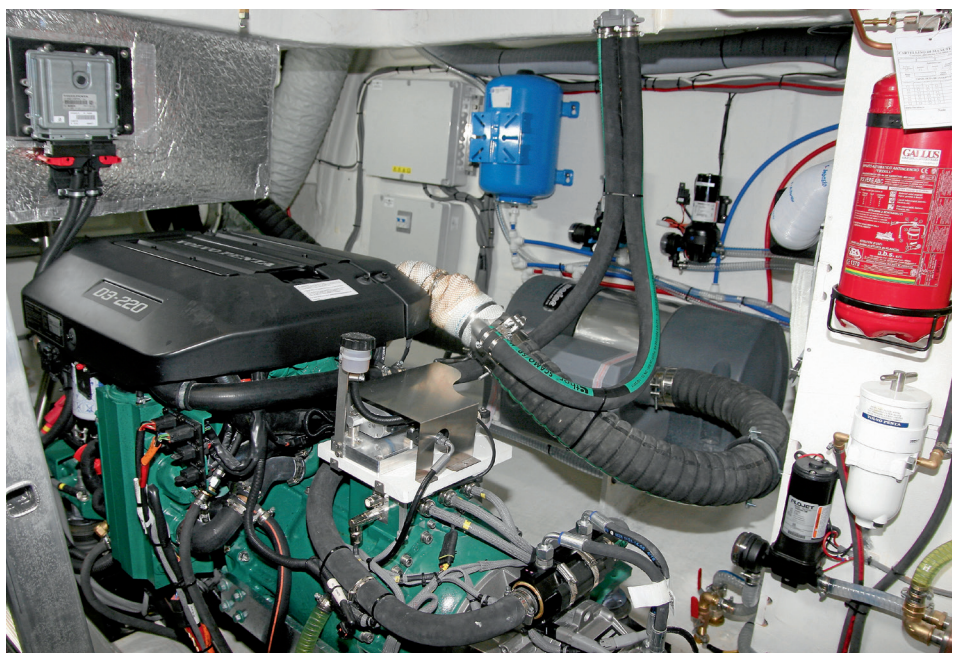
Eine der beiden Maschinen mit V-Drive. Zwischen Dieselmotor und Getriebe sitzt der Elektromotor.
