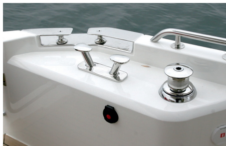
Ein elektrisches Verholspill mit Rollenklüse ist auf beiden Seiten des Decks angebracht.
