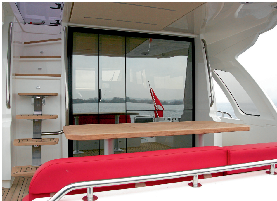
Achtere Sitzgruppe und Treppe zur Flybridge. Die Falttüre und die Verglasung des Aufbaus kann ganzflächig geöffnet werden.
