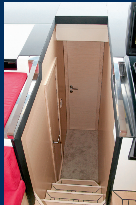
Im schmalen Niedergang zu Vorschiffs- und Unterflurkabine kann man sich bei Seegang an den Wänden abstützen. Ein Handlauf wäre trotzdem wünschenswert.
