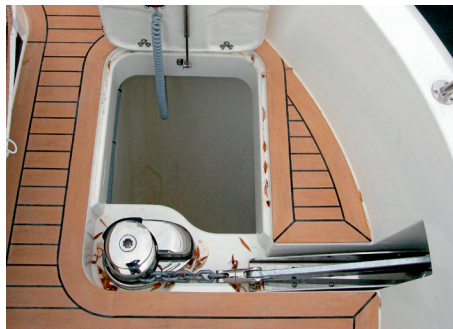
Ankerkasten mit tiefer Kettenlast und Elektrowinch.
