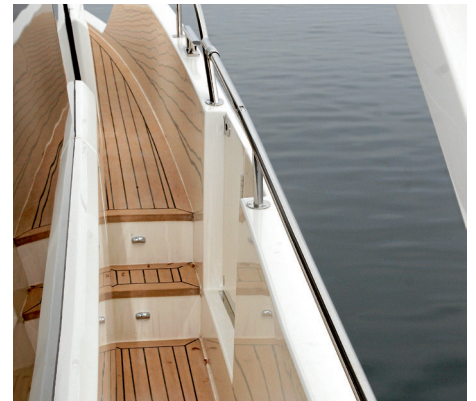
Durch die Öffnung im Schanzkleid gelangt man schnell vom Fahrstand auf den Kai oder Steg.
