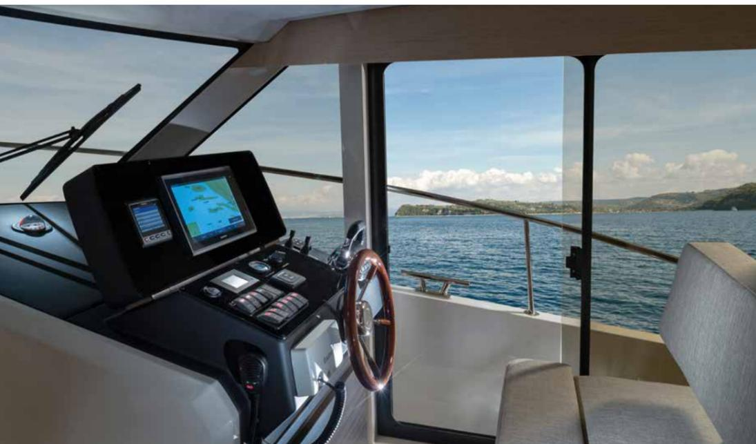
An Stb. befindet sich der übersichtliche Steuerstand mit den Bedienelementen für den Diesel- und den E-Antrieb, den Bugstrahlern, den Tabs sowie einem davor aufgepflanzten Geräteträger für einen grossen Plotter (Option). Gut gefallen hat uns die Rauchglas-Schiebetür rechts vom Steuerstand, die es ermöglicht, schnell nach aussen auf den Gangbord zu gelangen.
