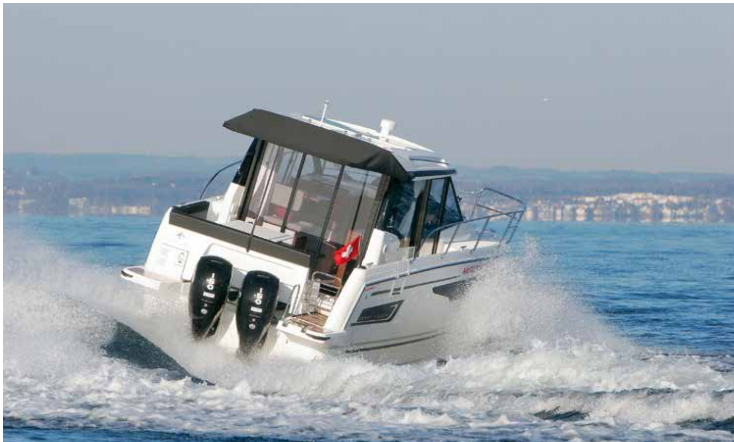
Zweimal 150 PS am Heck: Die Motoren wurden von GP-Marine in Romanshorn mit Katalysatoren ausgerüstet und besitzen eine Bodenseeulassung.
