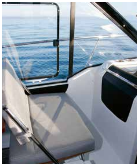
Die Rückenlehne lässt sich umklappen, sodass der Sitz in beide Richtungen nutzbar ist.
