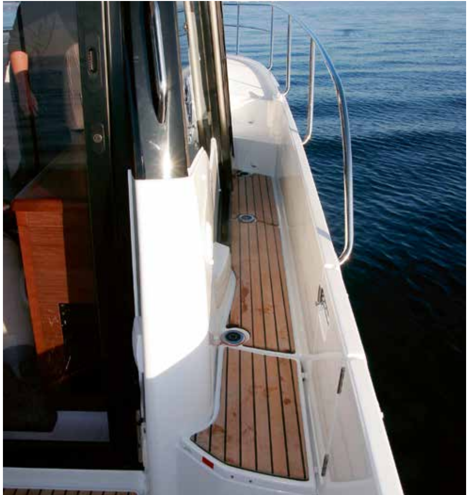
Das „Pilot-House“ ist asymmetrisch versetzt. Dadurch ergibt sich ein bequemer und sicherer Weg aufs Vordeck hinter einem Schanzkleid, das über eine Türe verfügt.
