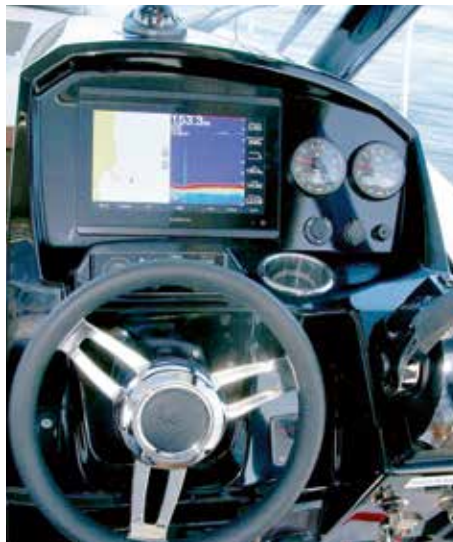
Cockpit mit Multifunktionsbildschirm und analogen Instrumenten für die Motorüberwachung.
